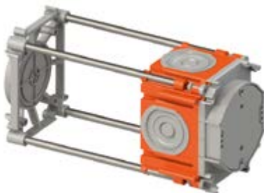
длина распорных стержней = толщина стены - 45 мм
